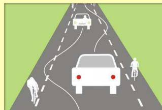
Il s'agit d'une chaussée à voie centrale banalisée sans marquage axial et bordée de deux couloirs. Les véhicules motorisés circulent sur la voie centrale bidirectionnelle et les cyclistes sur les accotements appelés "rives".
